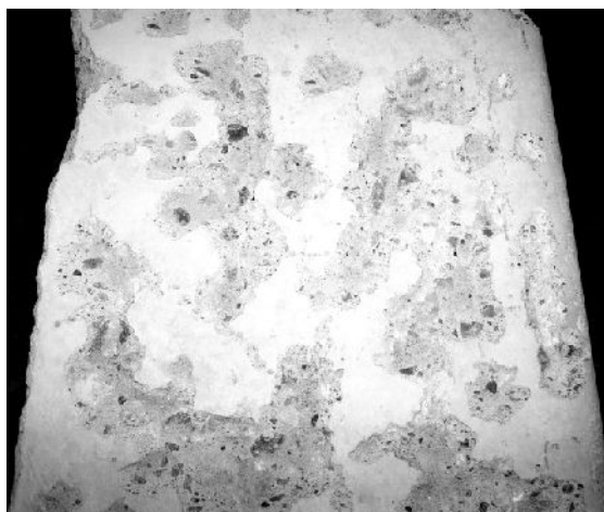
Рис. 5. Шероховатая поверхность усиленной балки
