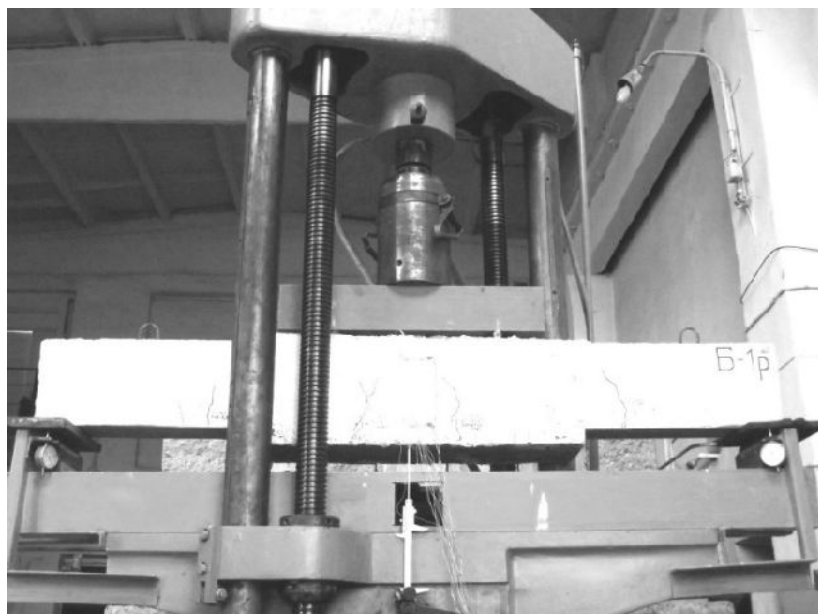
Рис. 2. Испытательная машина ГРМ-1 и готовая к эксперименту усиленная балка Б-1р.
